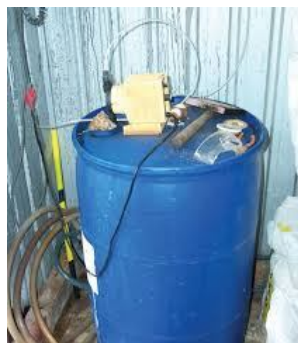
شکل ۶- سیستم خودکار تزریق اسید به داخل آب آبیاری
