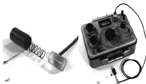
شکل 1- شوری سنج با الکتروود جاسازی شده در داخل صفحه سرامیکی (الف) به همراه دستگاه قرائت‌گر آن (ب) (Rhoades, Chanduvi et al., 1999)
