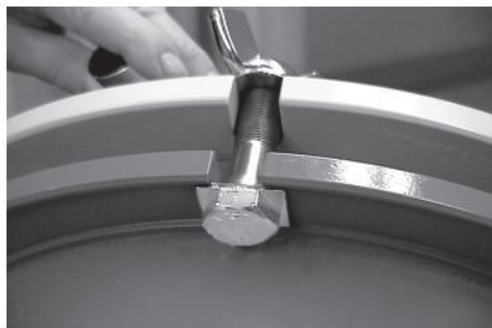
شکل 8- نحوه قرارگیری صحیح پیچ‌های با سر مستطیل شکل در شیارهای بدنه دستگاه
