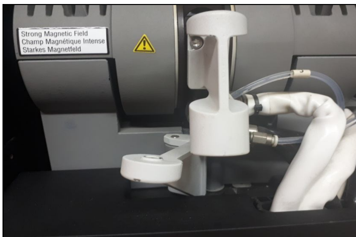
شکل ۲۵- آزاد شدن بازوی نگهدارنده لوله گرافیتی
