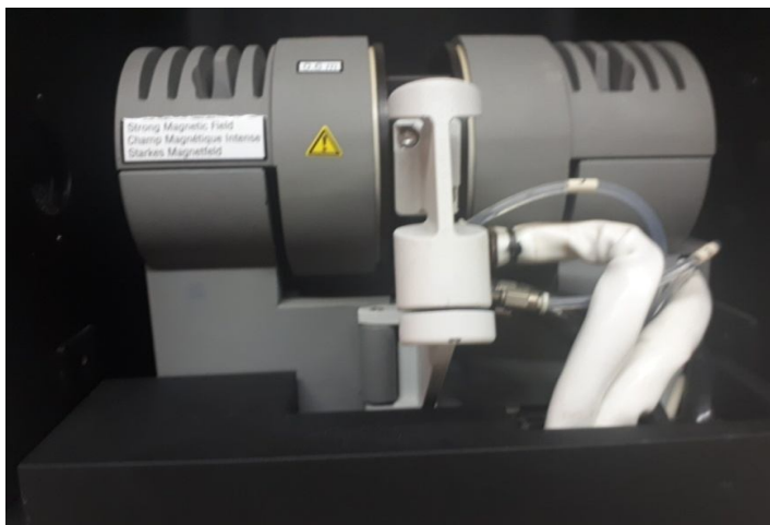
شکل ۲۴- بازوی نگهدارنده لوله گرافیتی در حالت قفل
