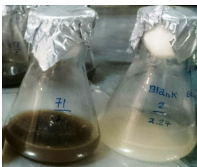
شکل 11- تولید رنگ‌دانه قهوه‌ای محلول در آب توسط A. salinestris (چپ) در مقایسه با محیط کشت شاهد (راست)؛ (خسروی، 1398)
