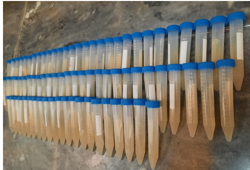
شکل 8- شیوه قرار دادن لوله‌ها روی سطح شیب‌دار
