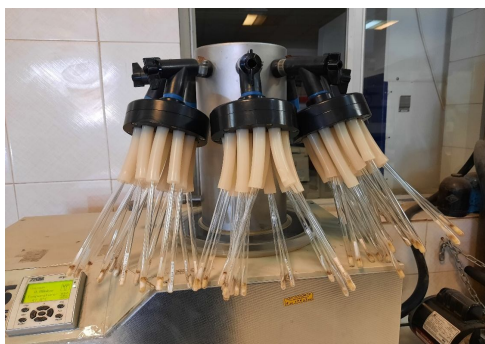
شکل 3- اتصال لوله‌های دارای باکتری به چمبر دستگاه فریز درایر
