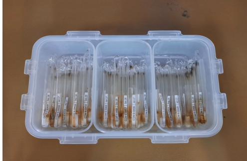
شکل 4- ذخیره لوله‌ها پس از برش در دمای 4 درجه سلسیوس
