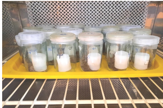
شکل 8- نمونه‌های خاک انکوبه شده در مجاورت محلول NaOH
