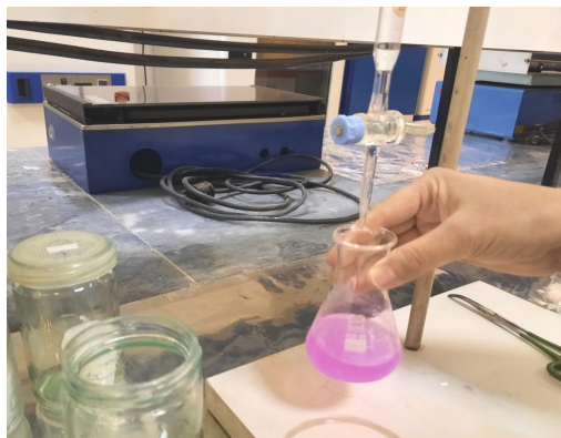
شکل 9- مرحله تیتراسیون نمونه با استفاده از HCl
