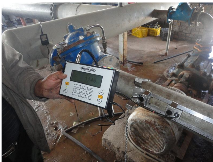
شکل 12- نمونه‌ای از تجهیزات اندازه‌گیری دبی در محل ایستگاه پمپاژ آب کشاورزی (بوسف گمرکچی، 1396)
