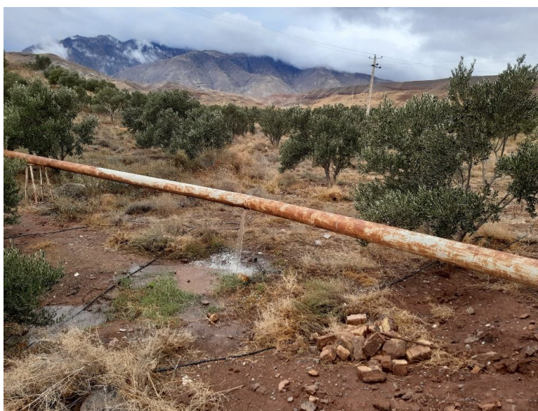
شکل 4- نمونه‌ای از تأثیر خوردندگی آب آبیاری بر روی خط انتقال آب کشاورزی (بوسف گمرکچی، 1398)
