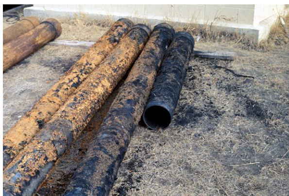
شکل 7- نمونه‌ای از تاثیر باکتری‌های آهن بر خوردندگی لوله‌های فلزی درون چاهی (منبع، بی نام)
