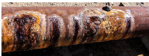
شکل 6- نمونه‌ای از تاثیر خوردندگی آب آبیاری بر روی خط انتقال آب (منبع، بی نام)
