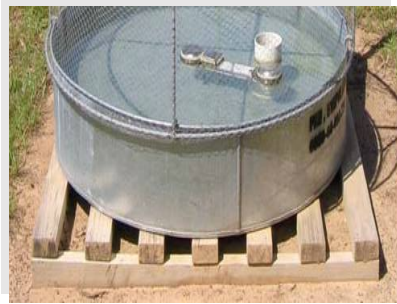
شکل 5- ایستگاه لایسیمتری تحقیقات خاک و آب کرج و لایسیمتر زهکش‌دار برای اندازه‌گیری تبخیر- تعرق سطح مرجع (چمن)
