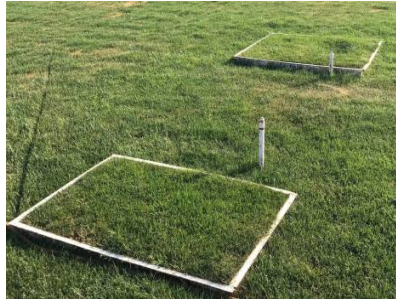
شکل 5- ایستگاه لایسیمتری تحقیقات خاک و آب کرج و لایسیمتر زهکش‌دار برای اندازه‌گیری تبخیر- تعرق سطح مرجع (چمن)
