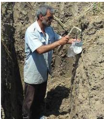
شکل 3-1. احداث پروفیل خاک برای شناخت ویژگی‌های خاک در لایه‌های زیرین جهت احداث باغ
