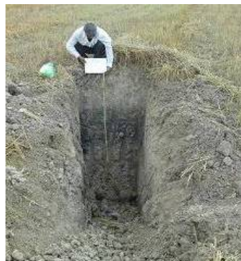
شکل 3-1. احداث پروفیل خاک برای شناخت ویژگی‌های خاک در لایه‌های زیرین جهت احداث باغ
